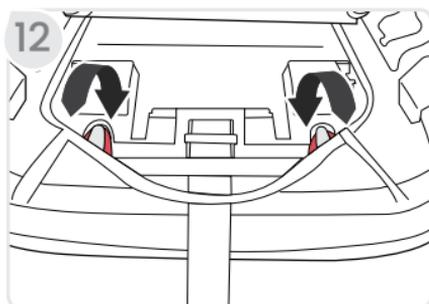
13. **Ponga** la cubierta inferior alrededor de la carcasa y coloque las dos (2) correas elásticas en la parte inferior del asiento de seguridad para niños.
