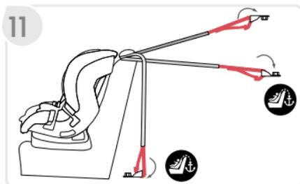
12. **Tire** del extremo suelto de la correa de amarre para quitar la holgura y **asegurar** el exceso de correa con la banda elástica colocada.
