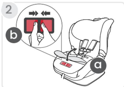
3. **Apriete** el resorte del enganche del anclaje inferior y levante el anclaje inferior.
