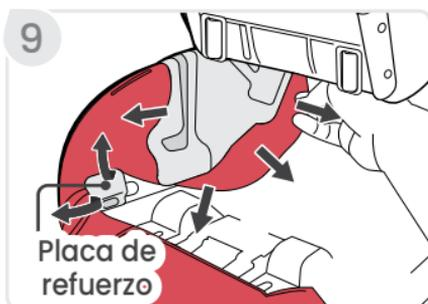
10. **Quite** las lengüetas plásticas en la parte exterior debajo de la guía del cinturón con orientación hacia atrás a cada lado.
