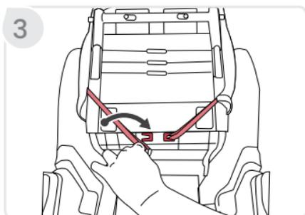
**NOTA:** Asegúrese de que la hebilla pase por la ranura de la cubierta correcta para la posición deseada de la hebilla.
