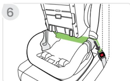
7. **Empuje** hacia abajo en la unión respaldo-cojín del asiento de seguridad con una fuerza moderada (aproximadamente 20,4 kg/45 lb), comprimiendo el asiento del vehículo, mientras que apriete el cinturón del vehículo.
