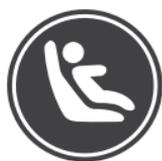
El símbolo de la izquierda se utiliza para ayudar a identificar la ubicación de los anclajes inferiores en los vehículos y los enganches de los anclajes inferiores de su sistema de retención infantil. Cuando instale el sistema de retención infantil utilizando los enganches de los anclajes inferiores, busque este símbolo en su vehículo y el símbolo correspondiente en su sistema de retención infantil para fijar los anclajes inferiores a los anclajes inferiores apropiados.
