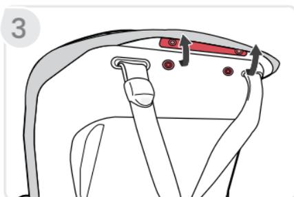
5. **Tire** la cubierta del borde exterior superior hacia adelante desde los paneles laterales.
