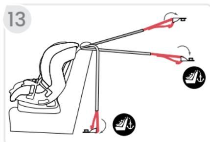
14. **Tire** del extremo suelto de la correa de amarre para quitar la holgura y asegurar el exceso de correa con la banda elástica colocada.
