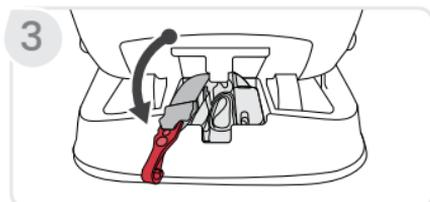
3. **Quite** los enganches de los anclajes inferiores del compartimiento de almacenamiento (ubicados en la parte trasera del asiento).
