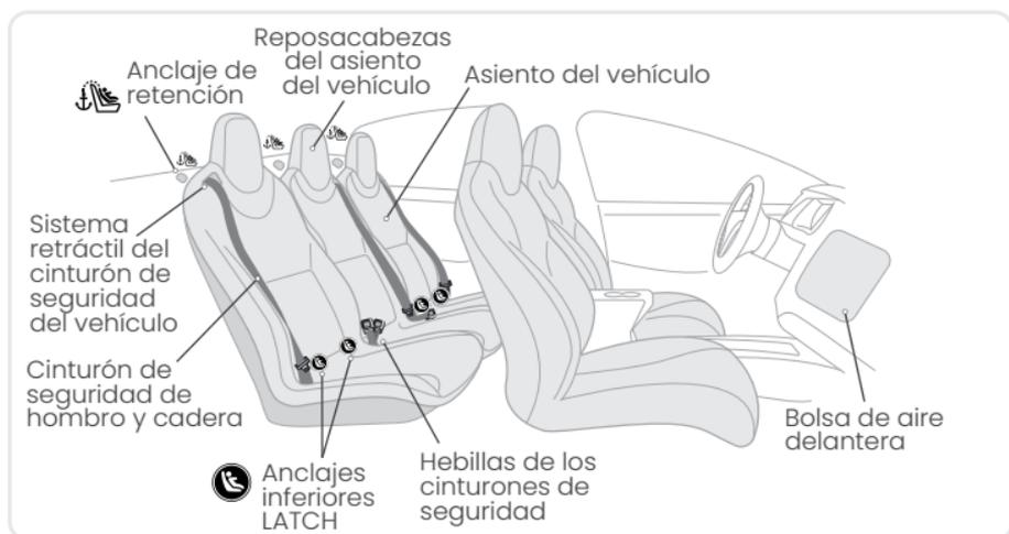
El sistema de anclaje de sujeción infantil, es un sistema disponible en este sistema de retención infantil que ofrece una alternativa a los métodos de instalación del cinturón del asiento del vehículo. La figura de arriba muestra lugares típicos para anclajes inferiores y correas de sujeción en un vehículo. Consulte la página 3 para los componentes del sistema de anclaje de sujeción infantil en este sistema de retención infantil.
