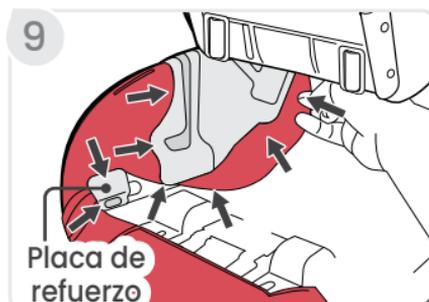
10. **Tire y ponga** las lengüetas plásticas en la parte exterior debajo de la guía del cinturón con orientación hacia adelante a cada lado.
