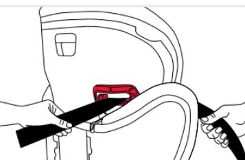
3. Pase la parte subabdominal del cinturón de seguridad por debajo de los reposabrazos derecho e izquierdo por encima de ambas guías de cinturón.
