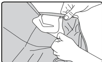
6. Jale la cubierta del alrededor del botón de ajuste del arnés y levante la cubierta fuera del exterior del asiento.
