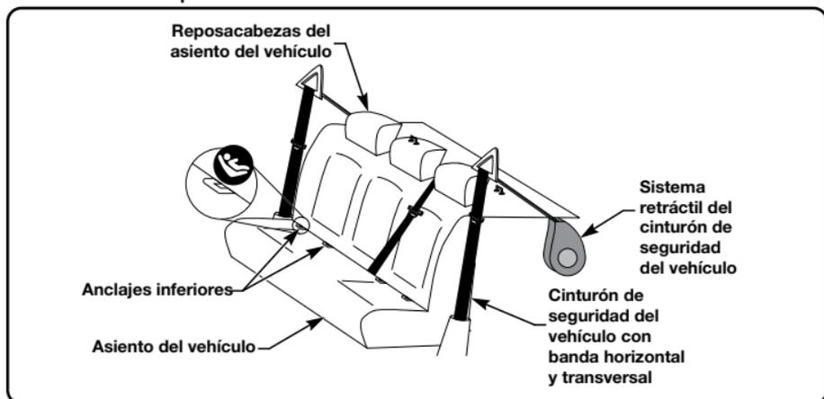
Consulte el manual del propietario de su vehículo para saber si está equipado con anclajes inferiores, el peso máximo de los anclajes inferiores y la información sobre las posiciones disponibles de los anclajes inferiores y de los asientos para su uso con este asiento para niños.
