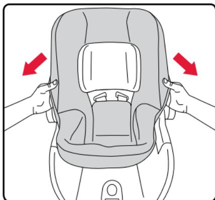
2. Jale la correa de ajuste del arnés por la cubierta y coloque la cubierta alrededor del botón de ajuste del arnés.
