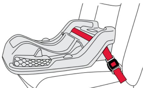
Instalación de la base con cinturón de banda horizontal
