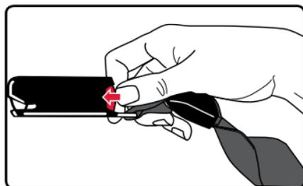
2. Apriete el conector inferior y levante del anclaje.
