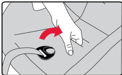
3. Jale el elástico para reemplazar la cubierta alrededor de las guías del cinturón por el asiento sin la base.
