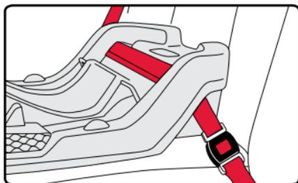
3. Presione la base firmemente sobre el asiento del vehículo mientras se quita toda la holgura de la primera parte del cinturón y, a continuación la parte del hombro del cinturón de seguridad del vehículo.
