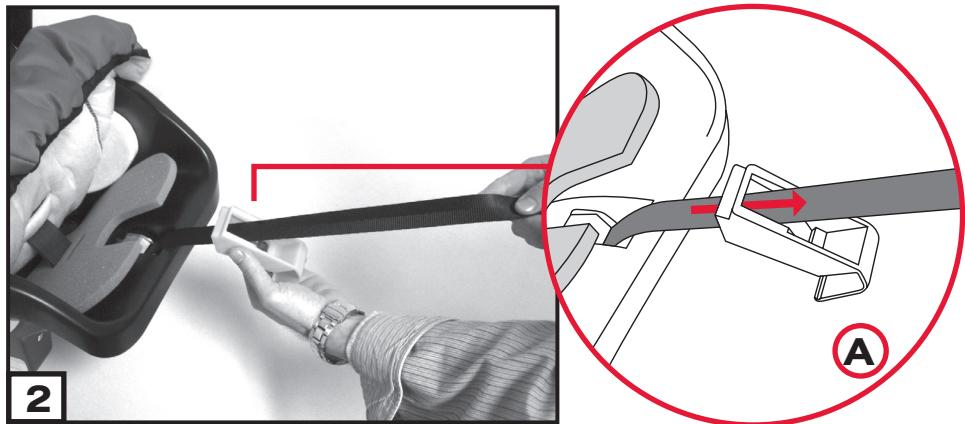
3. Orientez la pince de rétention d'ajusteur du harnais vers le bas en direction de l'assemblage du bouton de déverrouillage, jusqu'à ce que la partie supérieure de l'attache repose dessous le bord de la coquille.
