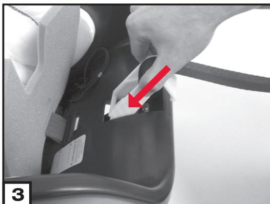
4. Appuyez sur l'extrémité de la pince de rétention d'ajusteur du harnais jusqu'à ce qu'elle s'enclenche dans l'extrémité de la coquille du siège d'auto pour bébé.
